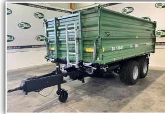
BRANTNER TA 10041 , Dreiseitenkipper, DLA, Bereifung 19.0/45 - 17, Bordwand 600 mm, Aufsatzwand 600 mm, Bordwandhebefedern
