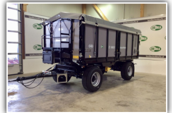
BRANTNER Z 18051 Multiplex , DLA mit ALB, Y-Zugdeichsel, Portaltüre links, Pendelwand links-rechts-hinten mit Zentralverriegelung, Planenaufbau, Stehpodest, Plateau 5110x2410mm, Aufbau 1560mm Multiplex 18mm
