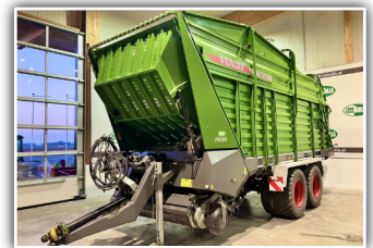
FENDT Tigo 50 MR Profi Ladewagen , Bj. 2019, 60m³ bei mittlerer Pressung, 31 Messer-Schneidwerk, vier Kratzbodenketten, Ladeautomatik, hydr. Frontwand, Bereifung 710/35 R22.5 Nokian, 66.500,- inkl. Verm.
