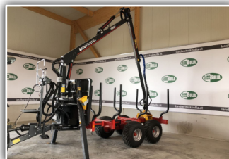
KÄLLEFALL FB 90 Rückewagen , Bj. 2023, 9 to Nutzlast - 11,2 to Gesamtgewicht, hydr. Lenkdeichsel, hydr. Trommelbremse, hydr. V-Type Abstützung, 3 to Endlosrotator, Forstkrane 6,9m, Euro Steuerung
