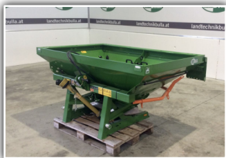
AMAZONE ZA-X 903 , Neumaschine, 900 l Inhalt, Zweischiebenstreuer, Grenzstreueinrichtung, 10 bis 18 m Abreitsbreite
