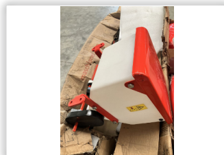
GASPARDO Mikrogranulatstreuer , zu MTR mit Düngestreuer, 5 und 6 Reihig, 16 l Behälter
