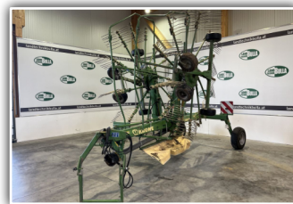
KRONE Swadro 800/26 , Bj. 2005, Arbeitsbreite hydr. Verstellbar von 680-760 cm, 2 Kreisel mit je 13 Zinkenarme, Transportfahrwerk mit Zwanglenkung, 13.400,- inkl. Verm.
