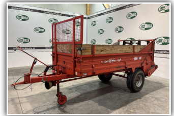
GRUBER SM35 Miststreuer , 3,5 t Nutzlast, 4 stehende Walzen, Streuwerk abnehmbar, Fräsklingen wendbar, Feinstreuwerk, 5.800,- inkl. Verm.
