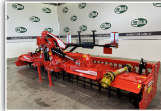
MASCHIO Falco 5000 Super , Neumaschine Bj. 2024, Arbeitsbreite 500 cm, Krumpenpackerwalze 500 mm, Gelenkwelle mit Nockenschaltkupplung
