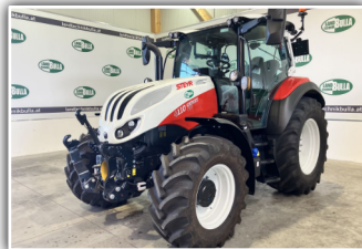
STEYR Expert CVT 4110 , Neumaschine, gef. VA, gef. Kabine, FZW, FH, Bereifung vorne 480/65 R24 und hinten 600/65 R34, 6x DW ZSTG, ISOBUS Verkabelung
