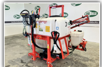
GASPARDO Sauro 800 , Inhalt 800 l, 12 m Gestänge, mech. Höhenverstellbar und klappbar, 5 Teilbreiten, Einspülschleuse, Reinwassertank, Gleichdruckarmatur
