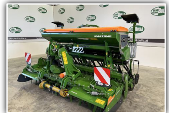
AMAZONE Säkombination KE 3002 mit Cataya Sämaschine , Vorführmaschine, 12 Kreisel, Trapezwalze, Twin Tec Doppelscheibenschar, ISOBUS mit elektrischen Antrieb
