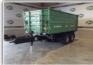
BRANTNER TA 16045 XXL , Dreiseitenkipper, Sattelstützwinde, Bereifung 500/50 R17, Bordwand 800 mm, Aufsatzwand 600 mm, Bordwandversteifung, Bordwandhebefedern, 40 km/h Ausführung
