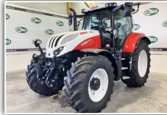
STEYR Profi 4125 S8 , Neumaschine, 24/24 Gang S-Control 8 Getriebe, 6x DW ZSTG, Bereifung hinten 650/65 R38 und vorne 540/65 R28, gef. und gebremste VA, Klasse 3.5 Vorderachse, FH
