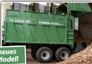
BRANTNER TA 16055 Power Push Plus , DLA + ALB, 16 to höchstzulässiges Gesamtgewicht, PU-Abdichtung für Getriedetransport, Bereifung 560/60 R22.5, 26 m³ Ladevolumen, Vorführer verfügbar
