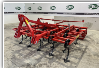
BRIX Unimax 300 Leichtgrubber , Bj. 2023, Arbeitsbreite 3 m, 4 Balken 60x60 mm, Gänsefußschare, Doppelwalzenkrümmler Beleuchtung
