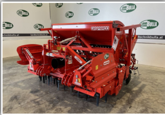
MASCHIO GASPARDO Sätkombination 2,5 m , Kreiselegge DC Classic, Zahnpackerwalze 500 mm, Sämaschine Dama 250, Corex Doppelscheibenschar, Saatstriegel einreihig, Fein und Normalstrad
