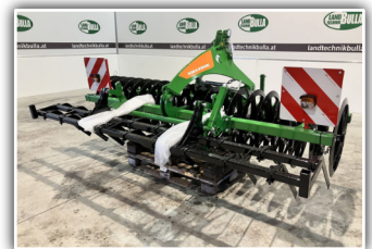
AMAZONE Nautilus 730 S Frontpacker , Neumaschine, 20 Ringe Modell W 280, Durchmesser 70 cm, 2-reihiges Messerzinkenfeld, Lenkbock, Beleuchtung
