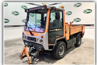
REFORM Bokimobil 1151 Kommunalfahrzeug , Bj. 2003, 106 PS, 100 km/h Bauartgeschwindigkeit, 5-fach Schaltgetriebe, Allrad, Fronthydraulik, 3 Seitenkipper, 14.800,- inkl. Verm.
