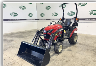
YANMAR SA 221 , Neumaschine mit Frontlader, Allradantrieb, Hydrostatischer Fahrtrieb mit 2 Geschwindigkeitsbereiche, 2x DW ZSTG, Heckzapfwelle 540 U/min, 16.800,- inkl. 20%
