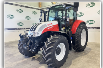
STEYR Multi 4120 , Neumaschine, gef. VA, gef. Kabine, 40 km/h ECO Getriebe, 4-fach Lastschaltgetriebe, 6x DW ZSTG, FH, S-Stop, Bereifung vorne 480/65 R24, hinten 540/65 R38, Multicontroller Armlehne
