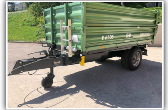
BRANTNER E 6535 Euro Line , hydr. Bremse, zul. Gesamtgewicht 6500 kg, Plateau 343 x 183 cm, Bordwand 50 cm, Aufsatzwand 50 cm, Getreideschieber, Bereifung 15.0/55-17
