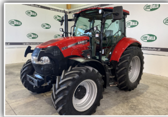
CASE IH Farmall 95 U Profi , Bj. 2015, 1955 h, Powershuttle und Lastschaltgetriebe, 24/24 Gang Getriebe, 5x DW ZSTG, Bereifung hinten 540/65 R34 und vorne 440/65 R24, Hydrac FL Konsole, 59.500,- inkl. Verm.
