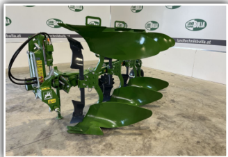
AMAZONE Cayros M950 , Neumaschine, 3 Schar, Pendelstützrad, Mollblech WL 430, Vorschäler, Scheibensech gezackt, Wechselspitze, Arbeitsbreite mechanisch verstellbar
