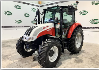
STEYR Kompakt 4065 S , Neumaschine, 12/12 Gang Synchro Shuttle Getriebe, 3x DW ZSTG, Bereifung vorne 14.9 R20 und hinten 16.9 R30, 8x Arbeitsscheinwerfer, ausstellbare Frontscheibe, Luftsitz
