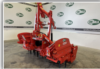
MASCHIO DC 2500 Classic , 2,5m Arbeitsbreite, ZW-Durchtrieb, Zahnpackerwalze, hintere Krümelschiene mit dezentraler Spindelverstellung
