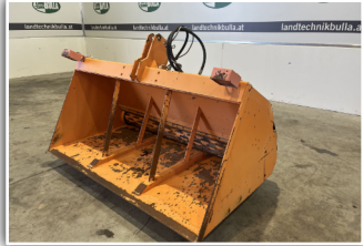
HYDRAC Splittstreuer SL 1800 R , 850 l, Streubreite 170 cm, mechanische Mengenregulierung, hydraulischer Antrieb durch Ölmotor, Beleuchtung, 1.850,- inkl. Verm.
