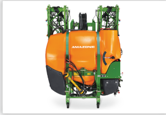
AMAZONE UF 1201 , Bj. 2025, 15 Meter Super S2 Gestänge, 7 Teilbreiten, ISOBUS Elektronik, Einspülschleuse, Innenreinigung, Abstellvorrichtung
