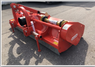
MASCHIO Tigre 280 , mech. Seitenverschiebung, Getriebe 540 u/min mit Freilauf, vordere und hintere Gegenschneide, Stützwalze, Gelenkwelle
