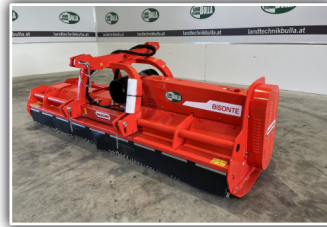
MASCHIO Bisonte 280 , Getriebe 1000 U/min mit Freilauf, Doppel-Dreipunkt für Front und Heckanbau mit hydraulischer Verschiebung, vordere und hintere Gegenschneide, Stützwalze 170 mm
