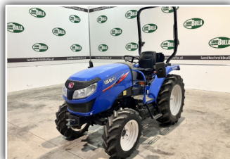
ISEKI TLR 3410 , Neumaschine, Stufenloses Getriebe mit Untersetzung, Allradantrieb, Bereifung 320/70 R24 hinten und 240/70 R15 vorne, 23.760,- inkl. 20%
