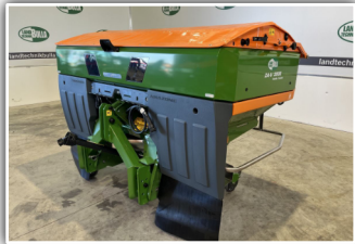
AMAZONE ZA-V 2000 Profis Tronic , Neumaschine, ISOBUS Elektronik, Wiegestreuer, Rollplane, schwenkbare Abstellvorrichtung, Neigungs- und Leermeldensensor, Inhalt 2000 l
