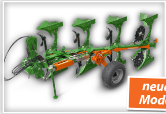
AMAZONE Teres 200 , Bj. 2025, 4 Schar Schar Pflug bis 200 PS, hydraulische und automatische Vorderfurcheneinstellung Auto Adapt, hydraulische Schnittbreite, hydraulisches Stützrad
