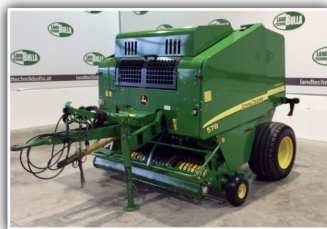
JOHN DEERE 578 Premium Rundballenpresse , Bj. 2007, 15.000 Ballen, Netzbindung, Walzenpresssystem, Schneidwerk, Bereifung 19.0/45-17, Bedienmonitor, 15.500,- inkl. Verm.
