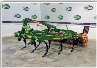
AMAZONE Cenius 3003 Special , Bj. 2024, Arbeitsbreite 3 m, Winkelwalze mit Federmessersystem, hydr. Tiefenverstellung, Einebnungsscheibe, Seitenschild
