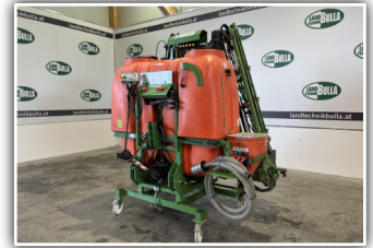
JESSERNIGG Starlight Feldspritze , Gestänge von 15 auf 12 m reduzierbar, 1200 l Inhalt, Hang und Pendelausgleich, hydr. Neigungsverstellung, Klappung und Höhenverstellung über Terminal, 19.200,- inkl. Verm.
