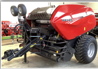
CASE IH RB 545 , Neumaschine, Bj. 2025, Fixkammerpresse, Ballendurchmesser 125 cm, 18x Presswalzen, Rotorschneidwerk mit 20 Messer, komplett absenkender Messerboden, Bereifung 500/60 x 22.5
