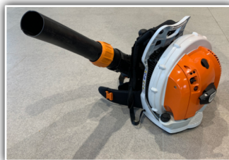
STIHL BR 700 Bläsergerät , Bj. 2023, 64,8cm 3 , 2,8/3,8 kW/PS, bis zu 1860m 3 /h Luftdurchsatz 920,- inkl.
