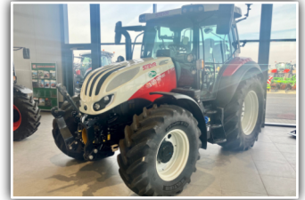
STEYR Expert CVT 4140 , Bj. 2025, FH, FZW, 480/65 R24 und 600/65 R34, S-Guide Lenksystemvorrüstung, gefederte Vorderachse, gefederte Kabine
