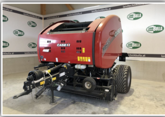
CASE IH RB 455 Variabel , Neumaschine, Bj. 2024, variable Ballenkammer 90 - 150 cm, 235 cm PickUp, seitliche Zuführschnecken, Rotorschneidwerk, Netzbindesystem, hydr. Pressdichtregulierung
