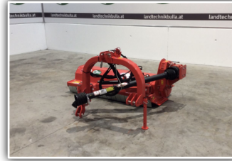
MASCHIO Giraffa M 190 , hydr. Seitenaussschwenkung und Neigungsverstellung, Arbeitsbreite 190 cm, Getriebe 540 U/min mit Freilauf, Stützwalze mit Abstreifschiene, gezahnte Gegenschneide
