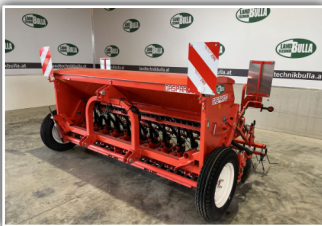
GASPARDO Nina 300 , 25 Corex-Scheibenschar, 12 cm Reihenabstand, elektr. Fahrgassenschaltung, Striegel, Nocken Sädräder für Normal- oder Feinsaat, abschaltbare Rührwelle, Zentrale Schardruckverstellung
