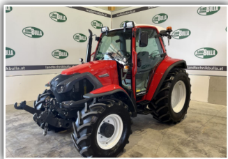
LINDNER Lintrac 75 LS , Bj. 2021, 360 h, Lastschaltgetriebe, Bereifung hinten 540/65 R30 und vorne 420/65 R20, EHR, Kabinenfederung, Kreuzhebel, ausstellbare Frontscheibe, 66.800,- inkl. Verm.
