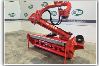
MASCHIO Giraffa 210 XL , Arbeitsbreite 210 cm, Rotor Arbeitsdurchmesser 410 mm, hydr. Seitenaussschwenkung und Neigungsverstellung, Hammerschlegel, Gleitkufen, Getriebe 540 U/min mit Freilauf
