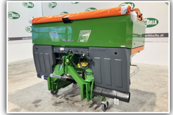
AMAZONE ZA-V 2600 Profis Tronic , Neumaschine, Wiegestreuer, ISOBUS Elektronik, Inhalt 2600 l, Limiter V+, Rollplane, schwenkbare Abstellvorrichtung, Leermelde- und Neigungssensor
