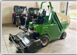
AMAZONE Profihopper 1500 , Vorführmaschine, 30 h, Stufe V 46 PS Motortechnik, Hochkipplentierung 250 cm, Arbeitsbreite 150 cm, Allradantrieb,
