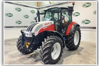
STEYR Kompakt 4090 , Bj. 2024, 380 h, 24/24 Gang Getriebe mit Power Shuttle und Lastschaltung, 5x DW ZSTG, Bereifung 540/65 R34 und 440/65 R24, FZW, FH, DLA, Multicontroller
