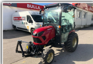
YANMAR SA 424 , Neumaschine, 26 PS, Hydrostatischer Fahrtrieb, 2 Geschwindigkeitsbereiche, Zwei-Pedal-Bedienung für Vorwärts/Rückwärts, Allrad, Fronthubwerk, Kabine
