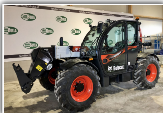
BOBCAT TL 43-80 HF Agri 3 , Vorführer, 100 h, Bj. 2025, Hubhöhe 7,5 m, Hubkraft 4,3 to, 40 km/h, 3 Lenkungsarten, Hydrostatischer Fahrtrieb, Zusatzhydraulik mit Zeit und Mengeneinstellung
