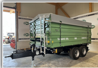
BRANTNER TA 16045 XXL , Dreiseitenkipper, Sattelstützwinde, Bereifung 445/45 R19.5, Bordwand 800 mm, Aufsatzwand 800 mm, Bordwandversteifung, Bordwandhebefedern, 40 km/h Ausführung, Plane
