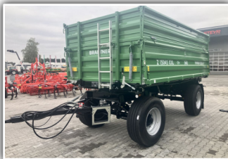
BRANTNER Z 15045 XXL , 2-Leiter DLA mit ALB, Bordwand 800 mm und Aufsatzwand 600 mm, aufklappbare Bordwände, Brückenmaß 4480x2250 mm, Öl und DLA Durchgang, Bereifung 385/65 R22.5
