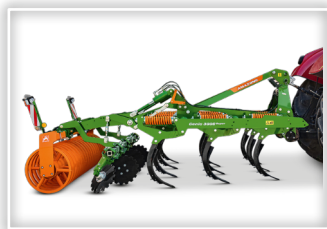
AMAZONE Cenio 3000 , Bj. 2025, 10 Zinken, Leistung bis 200 PS, Flexwalze, Zustricherscheiben, hydraulische Tiefenverstellung
