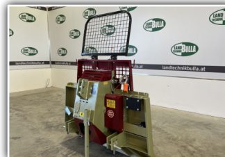
HOLZKNECHT HS 850 Funk , 8,5 to Zugkraft, 210 cm Schildbreite, 100m - 11mm gehäm. Seil, hydr. Seilausstoß, Seileinlaufbremse, Funk Bedienung mit Kipp Stopp, Zapfwellenanschluss mittig
