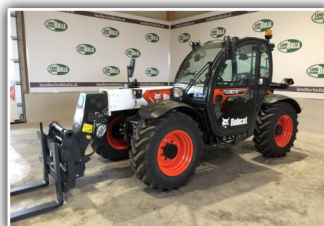
BOBCAT TL 30.70 Agri 3 , Vorführmaschine, Bj. 2024, 50h, Hubkraft 3 to, Hubhöhe 7 m, Hydrostatischer Fahrtrieb mit 2 Geschwindigkeiten, 3 Lenkungsarten, LED Beleuchtung, 40 km/h Typisierung, Zugmaul
