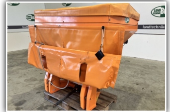
RAUCH Axeo 18.1 Q Winterdienststreuer , Bj. 2022, geschwindigkeitsabhängige Regelung, Bordcomputer Quantron K2, Prallblech zur Streuweitereinstellung, Abdeckplane, 9.500,- inkl. Verm.
