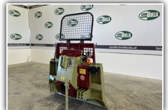
HOLZKNECHT HS 650 , 6,5 to Zugkraft, 175 cm Schild, 100m - 10mm Seil, Hydr. Seilausstoß, Seileinlaufbremse, Funk Autec, Schutzgitter klappbar, Zapfwellenanschluss mittig
