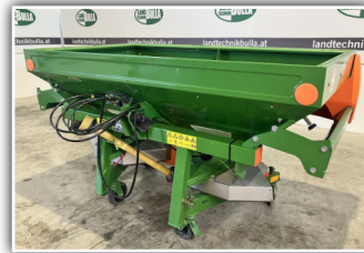
AMAZONE ZA-M 1001 Düngestreuer , Bj. 2012, Einfüllsiebe, Streuscheiben OM 10-16, Grenzstreuscheibe TS 5-9, Abstellräder gebremst, Gelenkwelle, Beleuchtung, 4.800,- inkl. Verm.
