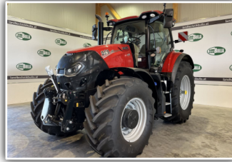
CASE IH Optum 250 CVX , Neumaschine, FH, Bereifung 600/70 R30 und 710/70 R42, 6x DW ZSTG, Load Sensing Anschlüsse, ISOBUS, HMC 2 VGM, Lenksystem vorbereitet, LED Scheinwerferpaket
