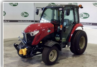
YANMAR YM 359 A - Stufenlos , Neumaschine, Kabine mit Lüftung, Heizung und Klimaanlage, Fronthubwerk Kat. 1, FZW, 2x DW ZSTG, Allradantrieb, LED Beleuchtung, Heckhubwerk mit 1620 kg Hubkraft
