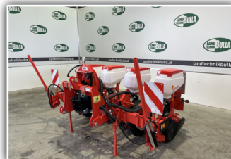
GASPARDO MTR 4 Reihig , Doppelscheibenschar, Zwischenandruckrolle INOX, hydr. Spuranreisser, hintere V-förmige 2" Andruckrollen, bis zu 150 kg Schardruck stufenlos einstellbar
