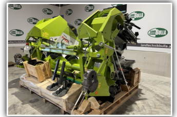
CLAAS Corio 670 FC Conspeed Maispflücker , Bj. 2023, 6 Reihen mit 70 cm Reihenabstand, Stoppelknicker, Gegenschneide - Kit, Spritzblech über Einzugswalze, Hybridwalzen
