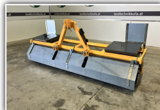
WALLNER Messerwalze , Vorführmaschine Bj. 2023, 3 m Arbeitsbreite, Tandemwalze - Messerwalze 1x glatt 1x gezackt, Durchmesser 380 mm, Zusatzgewichte, Beleuchtung
